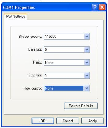
Fig. 3.3 Serial ports parameter setup
