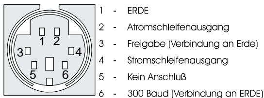
Abbildung 3. Buchse für verdrehte Doppelleitung
